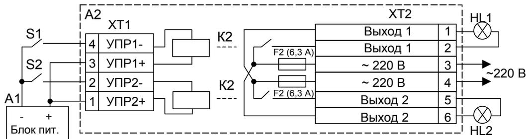
Рис 1 Схема подключения для исполнений УК-ВК и УК-ВК/01
